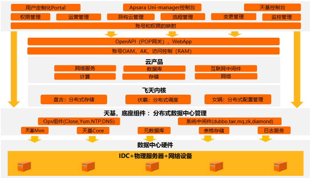
专有云敏捷版逻辑架构图（物理机）
