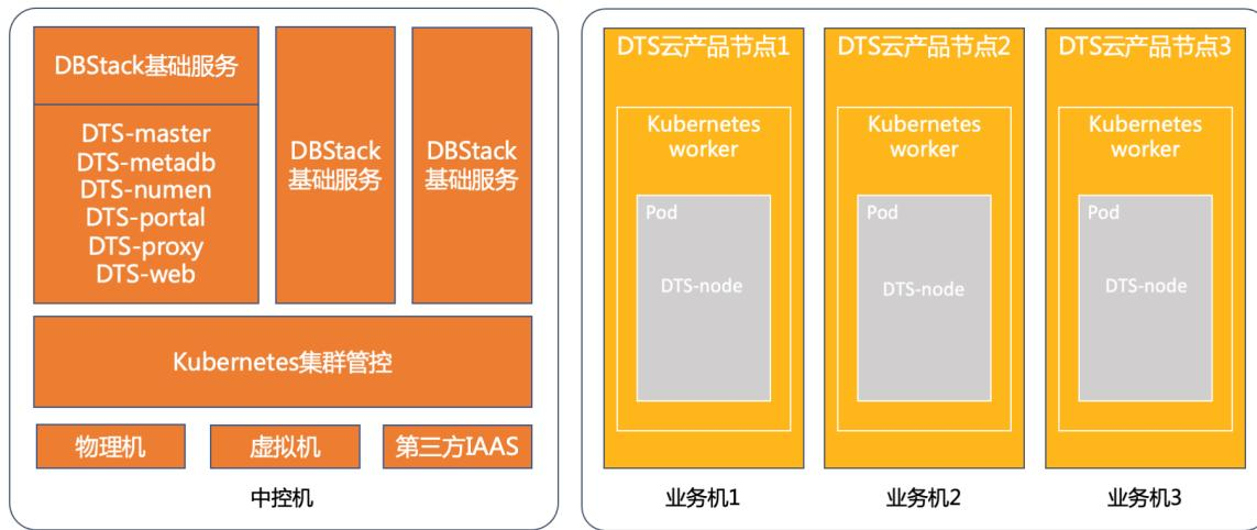
DTS的相关服务包括：DTS-node（worker节点）、DTS-master（调度）、DTS-metadb（元数据库）、DTS-numen（运维平台）、DTS-portal（控制台）、DTS-proxy（代理）、DTS-web（任务配置页面）。
