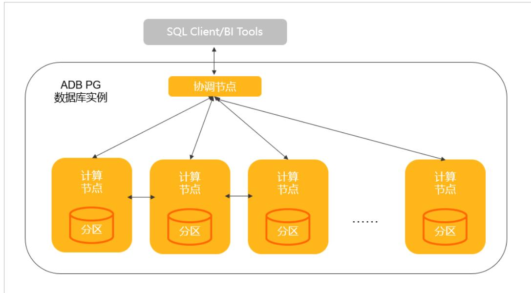
表数据可以按指定列的哈希（HASH）分布、随机（RANDOMLY）分布、复制（REPLICATED）分布在各个计算节点上，每个计算节点均为为主备（Primary/Minor）架构，保证数据双副本存储，节点间支持高性能网络通信。协调节点接收应用请求后，负责SQL语句的解析优化，并生成分布式执行计划，下发给计算节点，执行计划在计算节点间全并行执行（Massive Parallel Process）。
