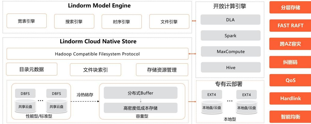
LindormStore提供性能型、标准型、容量型等多种规格，并且面对真实场景的数据冷热特点，支持性能型/标准型、容量型多种存储混合使用的形态，以适应真实场景的数据冷热特点，可结合多模引擎的冷热分离能力，实现冷热存储空间的自由配比，让用户的海量数据进一步享受云计算的低成本红利。
