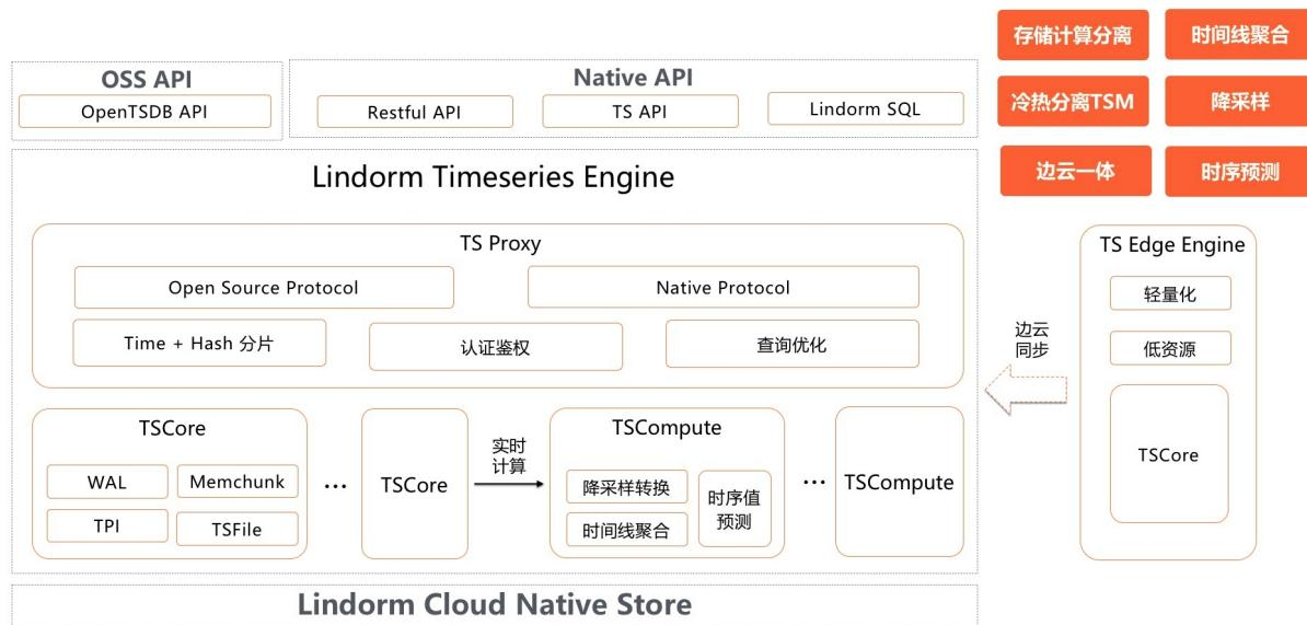
TSCore是时序引擎中负责数据组织的核心部分，其整体思想与LSM结构相似，数据先写入Memchunk，然后Flush到磁盘，但由于时序数据天然的顺序写入特征，定向专用的时序文件TSFile的结构设计为以时间窗口进行切片，数据在物理和逻辑上均按时间分层，从而大幅减少Compaction的IO放大，并使得数据的TTL、冷热分离等实现非常高效。
