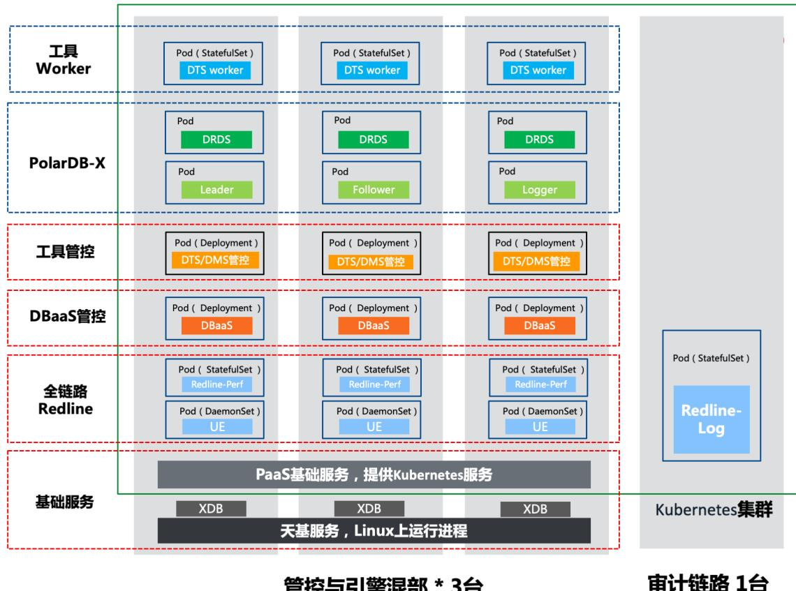
如上图所示，3台中控机内部构造包括管理进程（基础服务、全链路Redline服务、DBaaS管控服务、工具管控服务）、SQL审计服务以及数据库实例和DTS Worker。下面重点介绍管理进程：
