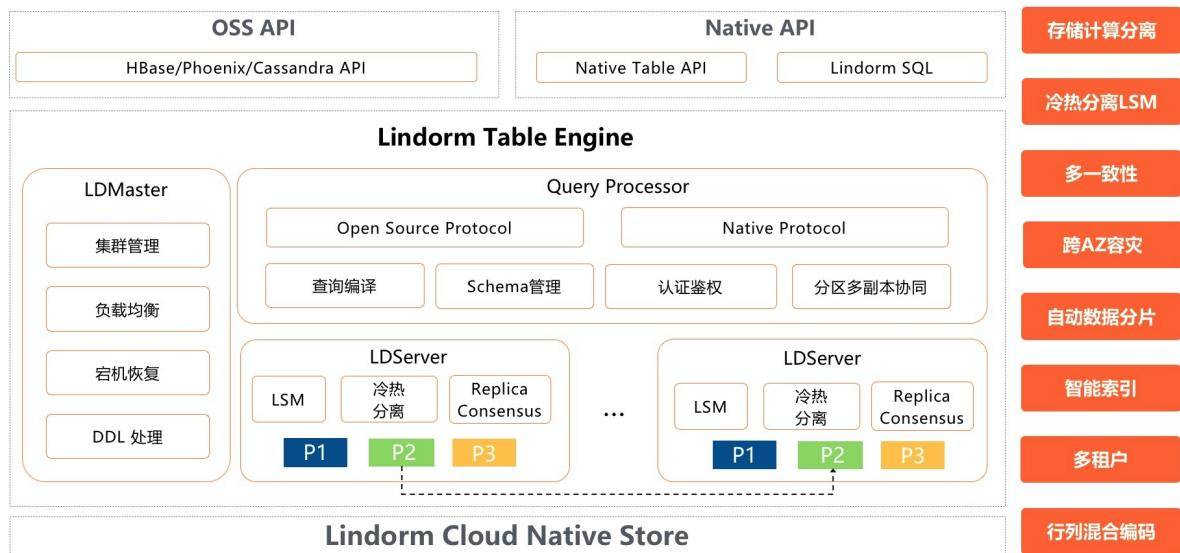
LindormTable的数据持久化存储在LStore中，表的数据通过自动Sharding分散到集群中的多台服务器上，并且每一个Partition可以拥有1至N个副本，这N个副本拥有主、从两种角色，主从副本可以加载在不同的Zone，从而保障集群的高可用和强一致。针对不同的一致性模式，主从副本之间的数据同步和读写模式如下：
