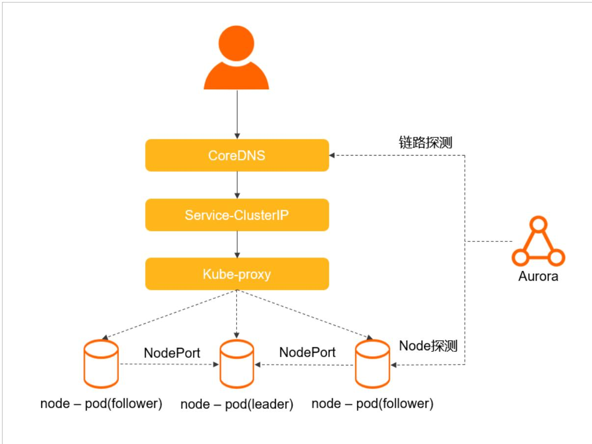
在DBStack中，RDS实例数据链路为Kubernetes链路，在创建实例（ReplicaSet）时会创建一个service，该service的流量策略为cluster，实例pod（replica）会绑定在Service中。Service的clusterIP会绑定到CoreDNS中，DNS地址提供用户访问。与其他场景相同，实例级别容灾都是由Aurora组件实现（实例切换、节点摘除）。
